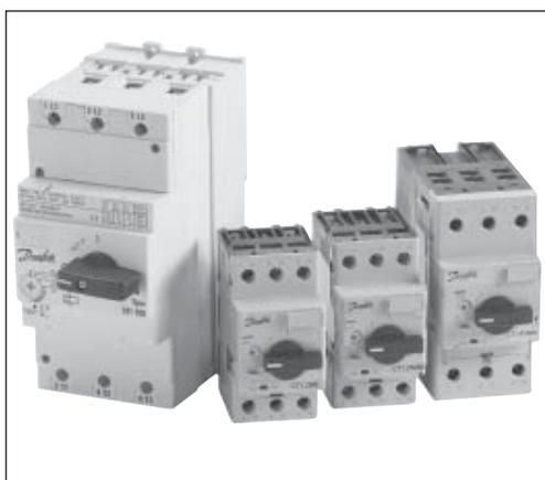
Los interruptores automáticos para protección contra cortocircuito y contra sobrecarga en motores y, los CTI 100 cubren el rango de corriente de 0.1 a 90 A, carga AC-3. La gama de interruptores automáticos está formada por tres grupos distintos de producto, según el tamaño. El primer grupo, el de menor tamaño es el CTI 25M, que comprende 13 códigos y cubre la gama de corriente de 0.1 a 25A. El grupo siguiente es el CTI 25MB que tiene
