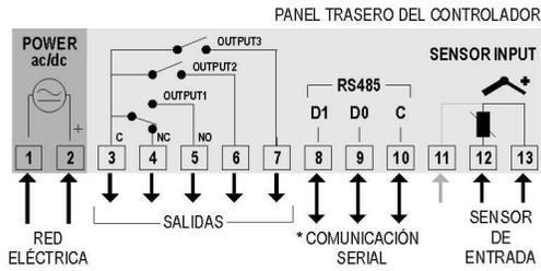
Figura 01 – Conexiones mostradas en la etiqueta del controlador
