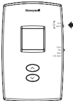
Utiliser le bouton-sélecteur **Fan** pour choisir le mode de fonctionnement du ventilateur.
