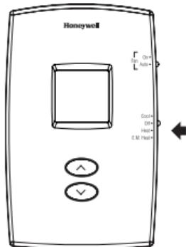
Utilizar el botón selector **SYSTEM** para poner el termostato en uno de los modos siguientes:
