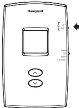
Utilizar el botón selector **Fan** para elegir el modo de funcionamiento del ventilador.
